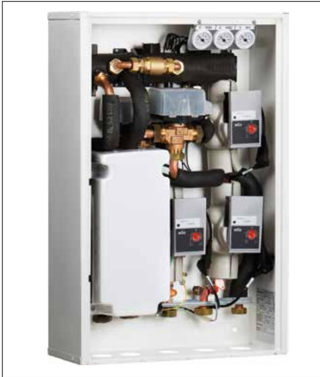
Due sistemi preconfezionati denominati: "**Kit 2 zone miscelate**" e "**Kit 2 zone miscelate e 1 diretta**". Sono costituiti da 2 collettori idraulici separati (mandata/ritorno) + by-pass, termometri per la lettura delle temperature, valvole miscelatrici motorizzate, elettropompe a basso consumo elettrico e schede d'espansione per la gestione elettrica.
