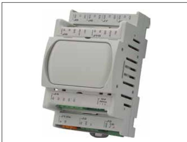
È un componente che deve essere alimentato a 24 Vac e serve principalmente per la gestione delle zone dell'impianto; in particolare occorre utilizzare n°1 kit espansione per ciascuna zona. Il kit espansione gestisce pompa, valvola miscelatrice e il deumidificatore della zona medesima acquisendo la richiesta ambiente (temperatura e umidità) per una determinata zona. A questo kit è possibile collegare:
